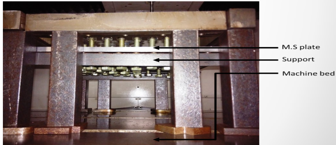
Actual bolt support setup
